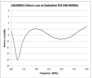
FIGURE 2.2 RETURN LOSS OF ANTENNA AT 698-960MHZ BAND AT REFERENCE LOCATION IN FREE SPACE
