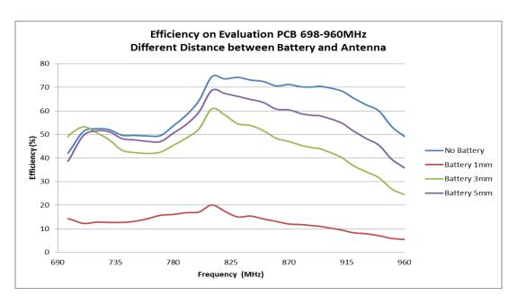
FIGURE 4.2.3 EFFICIENCY COMPARISON AT 698-960MHZ BAND OF DIFFERENT BATTERY DISTANCE FROM ANTENNA
