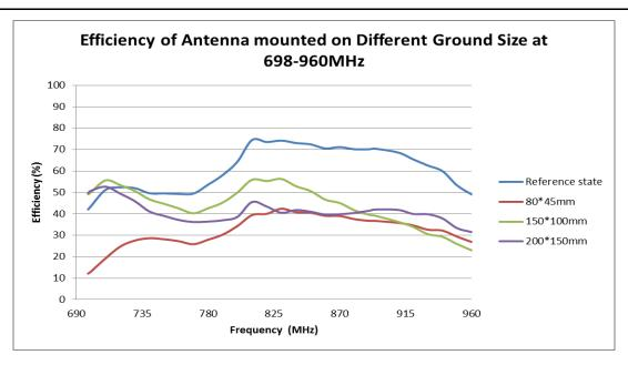
FIGURE 4.5.3 EFFICIENCY COMPARISON AT 698-960MHZ OF ANTENNA MOUNTED ON DIFFERENT SIZE GROUND
