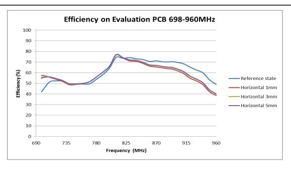
FIGURE 4.4.3 EFFICIENCY COMPARISON AT 698-960MHZ BAND OF DIFFERENT HORIZONTAL PLASTIC COVER DISTANCE FROM ANTENNA
