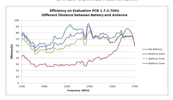
FIGURE 4.2.4 EFFICIENCY COMPARISON AT 1.7-2.7GHZ BAND OF DIFFERENT BATTERY DISTANCE FROM ANTENNA
