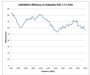
FIGURE 2.5 EFFICIENCY OF ANTENNA AT 1.7-2.7GHZ BAND AT REFERENCE LOCATION IN FREE SPACE
