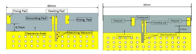
FIGURE 2.1: RECOMMENDED PCB LAYOUT
