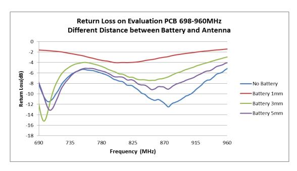
FIGURE 4.2.1 RETURN LOSS COMPARISON AT 698-960MHZ BAND OF DIFFERENT BATTERY DISTANCE FROM ANTENNA
