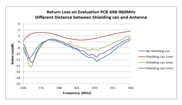
FIGURE 4.1.1 RETURN LOSS COMPARISON AT 698-960MHz BAND OF DIFFERENT SHIELDING CAN DISTANCE FROM ANTENNA
