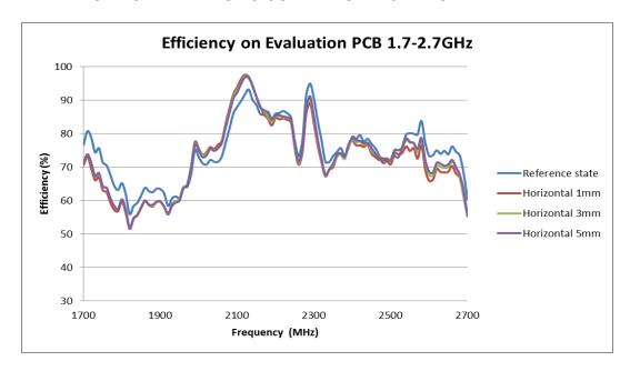
FIGURE 4.4.4 EFFICIENCY COMPARISON AT 1.7-2.7GHZ BAND OF DIFFERENT HORIZONTAL PLASTIC COVER DISTANCE FROM ANTENNA
