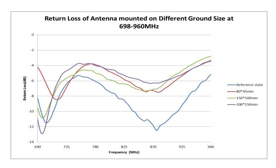
FIGURE 4.5.1 RETURN LOSS COMPARISON AT 698-960MHZ OF ANTENNA MOUNTED ON DIFFERENT SIZE GROUND
