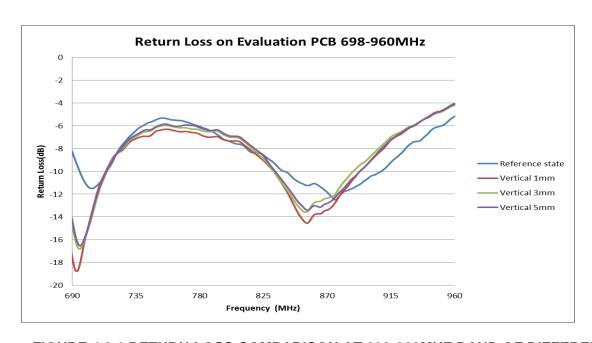
FIGURE 4.3.1 RETURN LOSS COMPARISON AT 698-960MHZ BAND OF DIFFERENT VERTICAL PLASTIC COVER DISTANCE FROM ANTENNA
