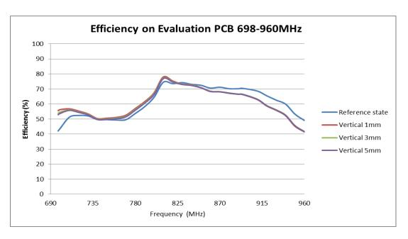
FIGURE 4.3.3 EFFICIENCY COMPARISON AT 698-960MHZ BAND OF DIFFERENT VERTICAL PLASTIC COVER DISTANCE FROM ANTENNA
