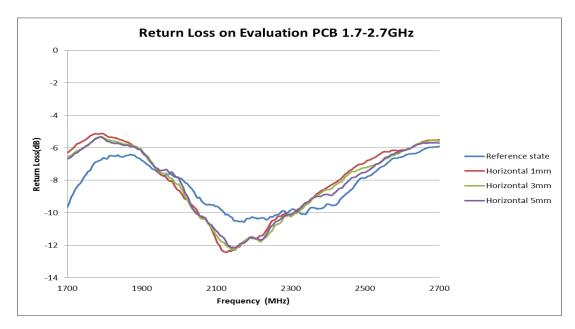
FIGURE 4.4.2 RETURN LOSS COMPARISON AT 1.7-2.7GHZ BAND OF DIFFERENT HORIZONTAL PLASTIC COVER DISTANCE FROM ANTENNA
