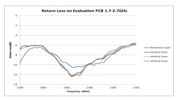
FIGURE 4.3.2 RETURN LOSS COMPARISON AT 1.7-2.7GHz BAND OF DIFFERENT VERTICAL PLASTIC COVER DISTANCE FROM ANTENNA
