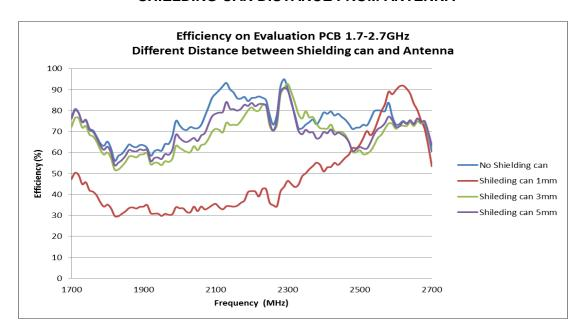
FIGURE 4.1.4 EFFICIENCY COMPARISON AT 1.7-2.7GHz BAND OF DIFFERENT SHIELDING CAN DISTANCE FROM ANTENNA
