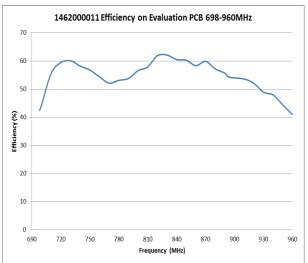
FIGURE 2.4 EFFICIENCY OF ANTENNA AT 698-960MHZ BAND AT REFERENCE LOCATION IN FREE SPACE
