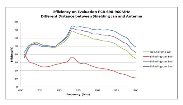
FIGURE 4.1.3 EFFICIENCY COMPARISON AT 698-960MHz BAND OF DIFFERENT SHIELDING CAN DISTANCE FROM ANTENNA
