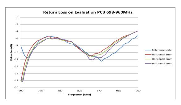
FIGURE 4.4.1 RETURN LOSS COMPARISON AT 698-960MHZ BAND OF DIFFERENT HORIZONTAL PLASTIC COVER DISTANCE FROM ANTENNA
