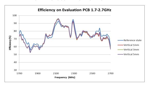
FIGURE 4.3.4 EFFICIENCY COMPARISON AT 1.7-2.7GHz BAND OF DIFFERENT VERTICAL PLASTIC COVER DISTANCE FROM ANTENNA
