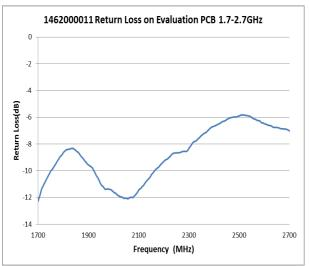
FIGURE 2.3 RETURN LOSS OF ANTENNA AT 1.7-2.7GHZ BAND AT REFERENCE LOCATION IN FREE SPACE
